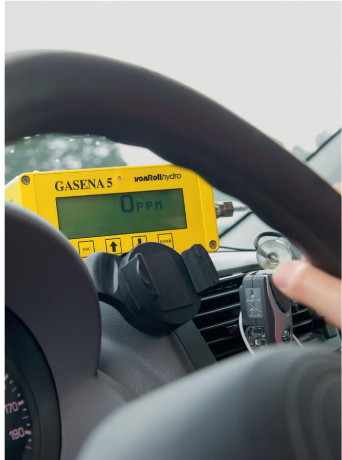
De conception compacte, léger et simple d'emploi, le GASENA 5 convient tout particulièrement aux applications mobiles et aux travaux de contrôles quotidiens. Le GASENA 5 détecte rapidement les moindres concentrations de gaz dans les puits ou les locaux et localise les fuites dans les conduites de gaz enterrées, les installations, les systèmes d'adduction de gaz, etc.
